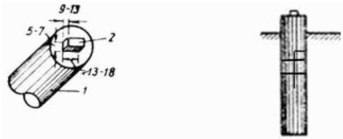
Рис. 18. Шип для насадки нижнего венца или обвязки:
