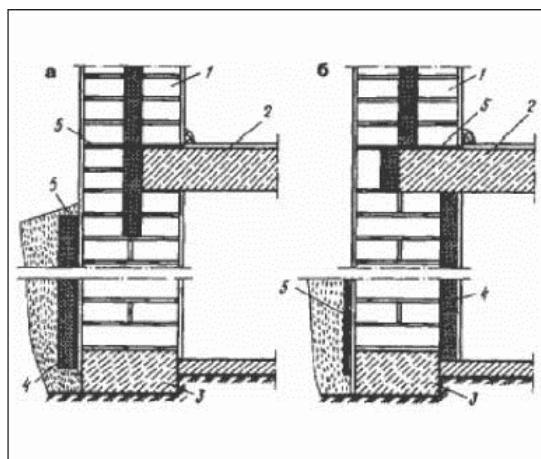
Утепление стен подвала следующими материалами: несгораемая каменная вата, экструдированный пенополистирол и др. современными материалами (рис. 10).
